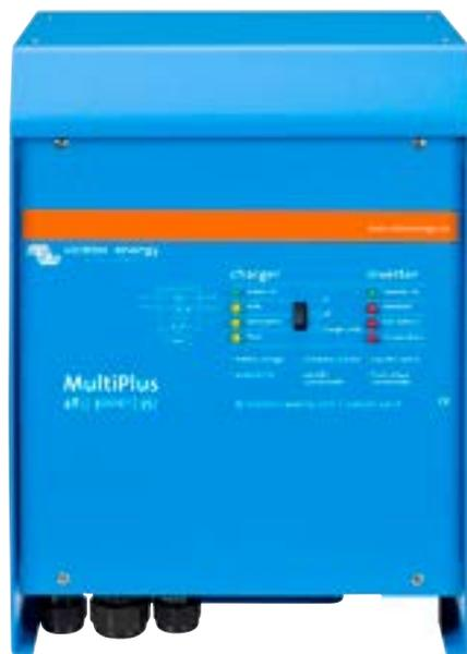
Многофункциональные инверторы MultiPlus от Victron Energy способны заряжать аккумуляторный парк напряжением 48 вольт от внешних источников, таких как генераторы и солнечные электростанции, преобразовывать постоянный ток от батарей в переменный с чистой синусоидой, а также, в режиме перегрузки пропускать через себя переменный ток сети общего пользования мощностью до 10кВт.
