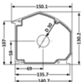
Рис.4 Геометрические размеры теплообменника СВК-А 2013
