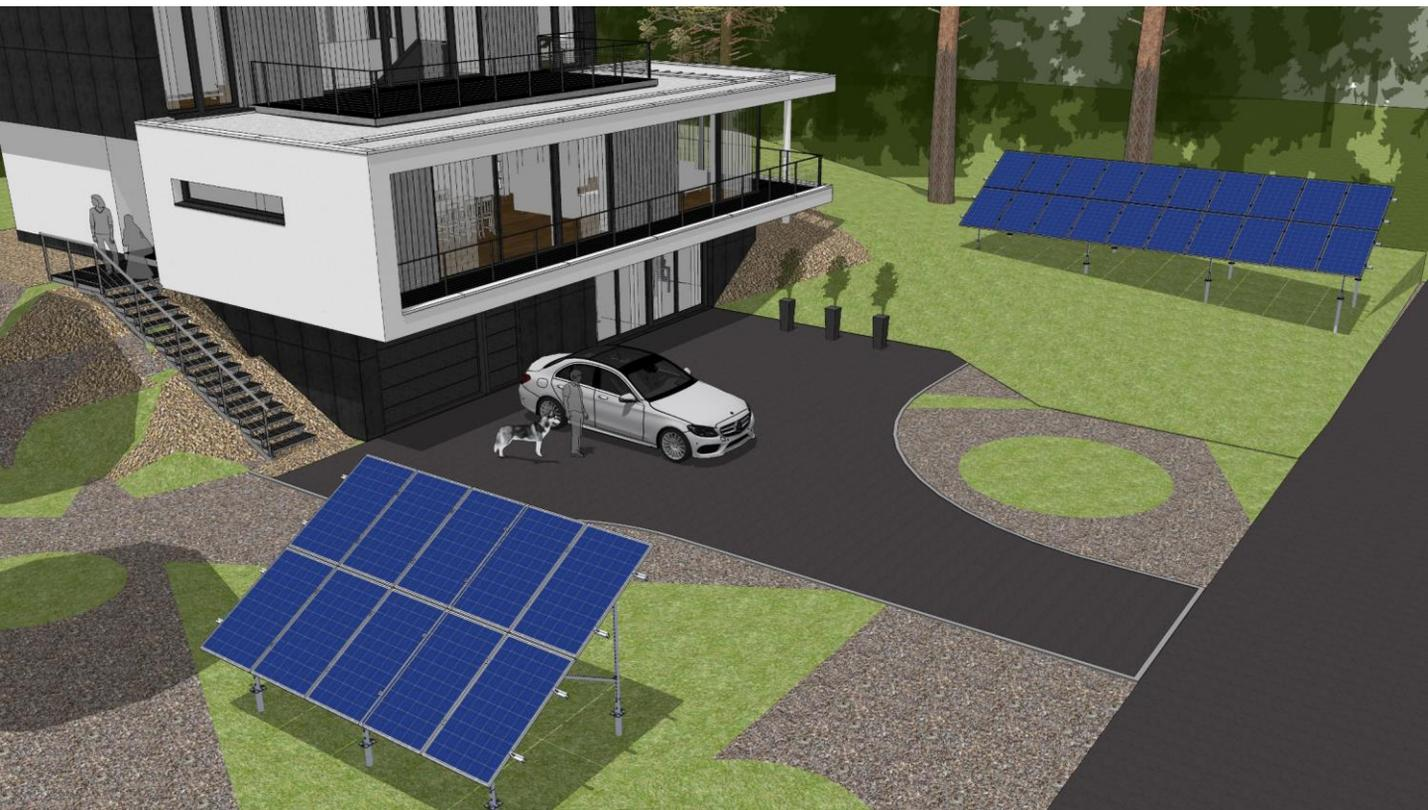
Kripter Domino – это комплекты из оцинкованной стали для наземного крепления PV модулей. Комплекты рассчитаны на установку от 10 фотомодулей, шаг между комплектами в продуктовой линейке составляет 2 модуля. Domino предназначены для фотомодулей размерами до 2100мм x 1005мм (60 и 72 ячейки), и толщиной рамы 35мм и 40 мм.
