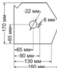
Рис.7. Геометрические размеры теплообменника СВК-А
