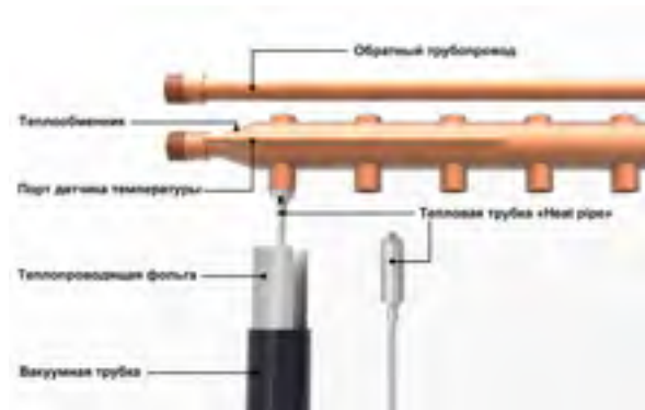
Рис 3. Конструкция теплообменника солнечного вакуумного коллектора
