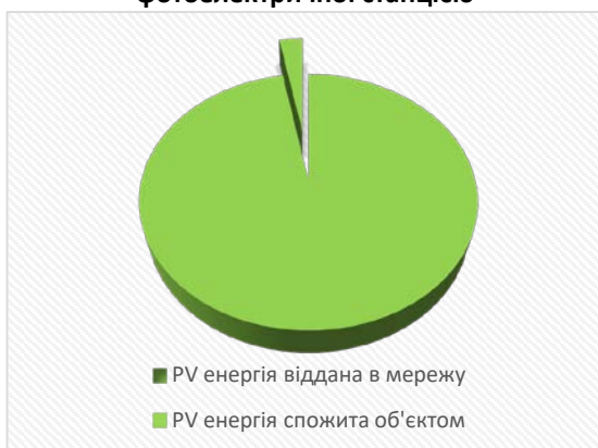
Графік розподілу енергії виробленої фотоелектричної станцією
