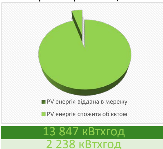
Графік розподілу енергії виробленої фотоелектричної станцією
